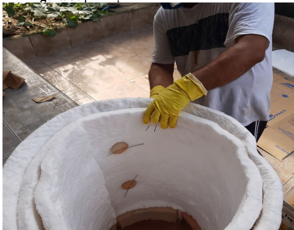
Figura 3: produção de forno cerâmico caseiro
